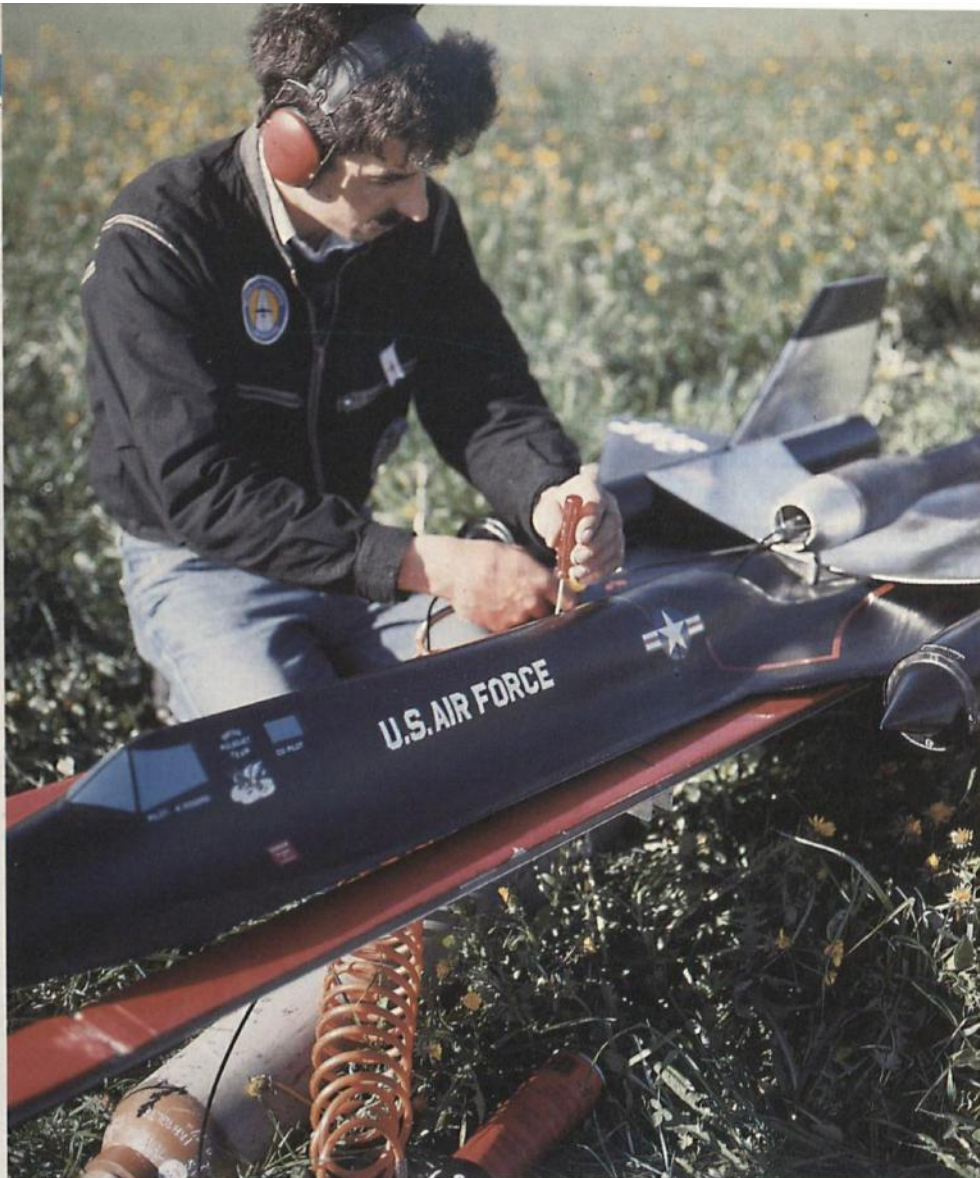
Fredi Andrist: In der rechten Hand hält er die Pressluftpistole. Mit der linken reguliert er das Treibstoffgemisch
